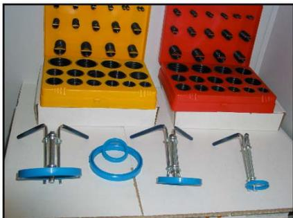
✓ **NUEVA HERRAMIENTA QUE PERMITE LA INSTALACIÓN DE TODO TIPO DE JUNTAS DE VÁSTAGO EN CUESTIÓN DE SEGUNDOS, DE FORMA EFICAZ Y LIMPIA.**
